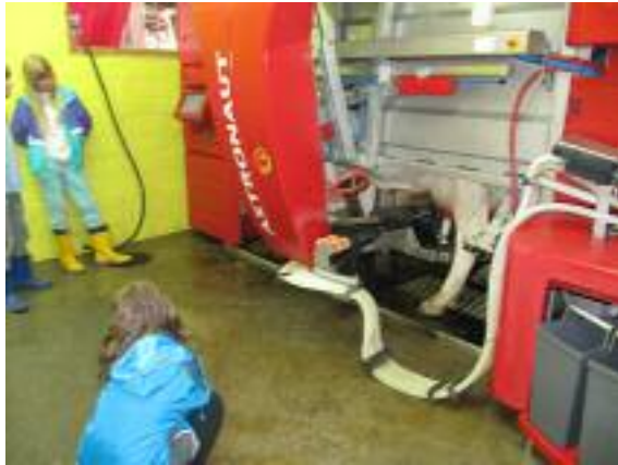
Der Melkroboter kann pro Tag 70 Kühe melken.
